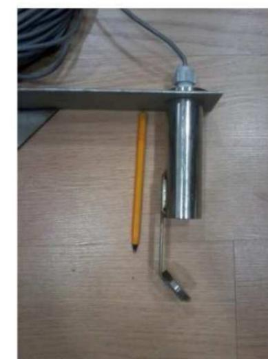
Figure 4. Protection de microphone utilisée sur le projet
